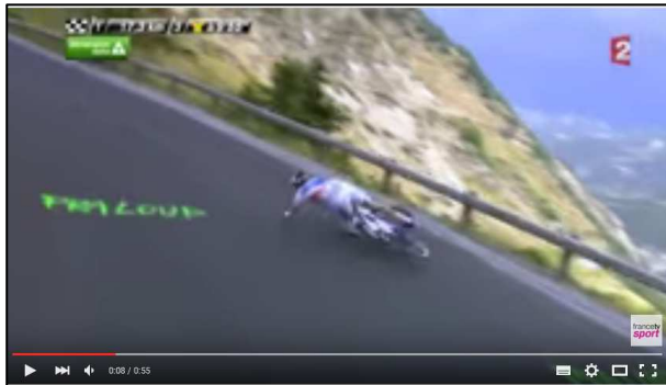
Image 4. La roue avant a glissé nettement plus que la roue arrière. Le vélo va se mettre de travers.
