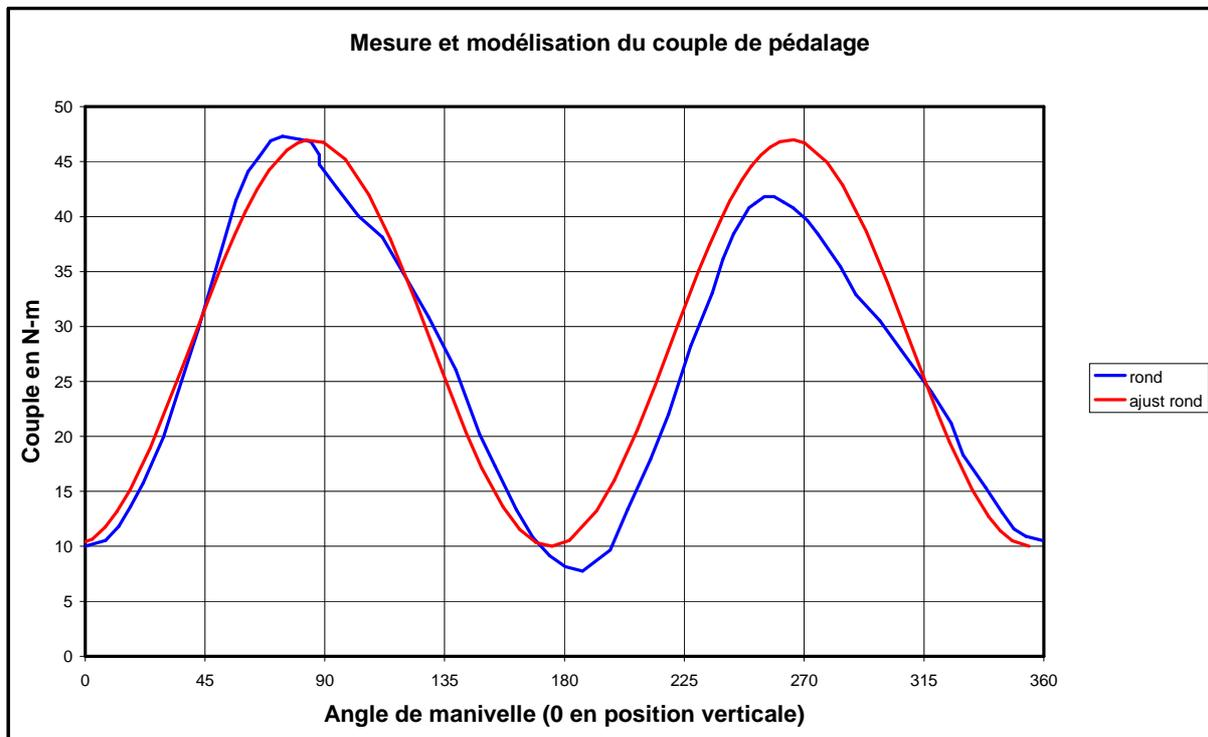
Fig.2. Mesure du couple moteur et sa modélisation
