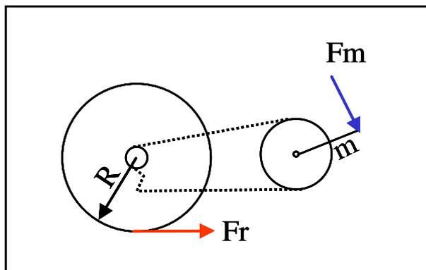
Fig.1. Couple moteur et couple résistant
