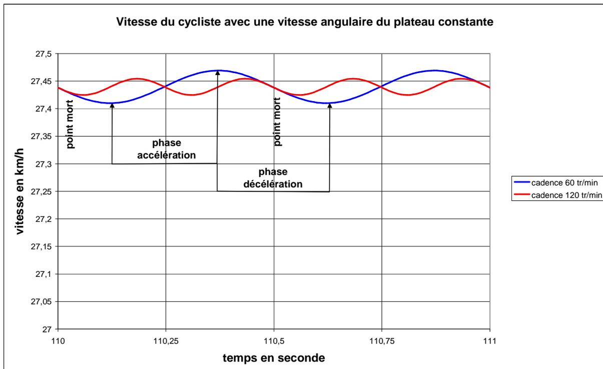
Fig.3. Vitesse du cycliste pour une vitesse angulaire de la manivelle constante
